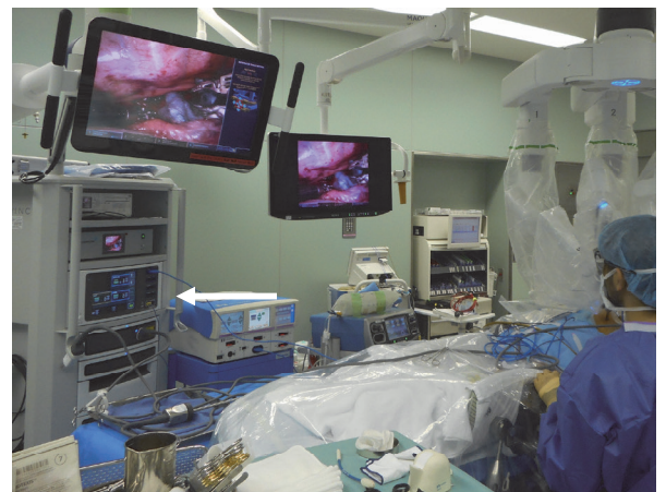
図1 C) 手術中のダヴィンチ3D映像を最適化する「ビジョンカート」(矢印)
