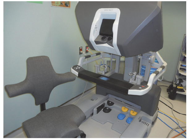
図1 A) 医師がダヴィンチを操作するための「サージョンコンソール」
